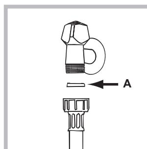
1. Вставте прокладку А у кінець шлангу для подачі води та вкрутіть його у кран з холодною водою з різьбою 3/4 (див. малюнок). Перед підключеннням спустіть воду, доки вона не стане прозорою.
